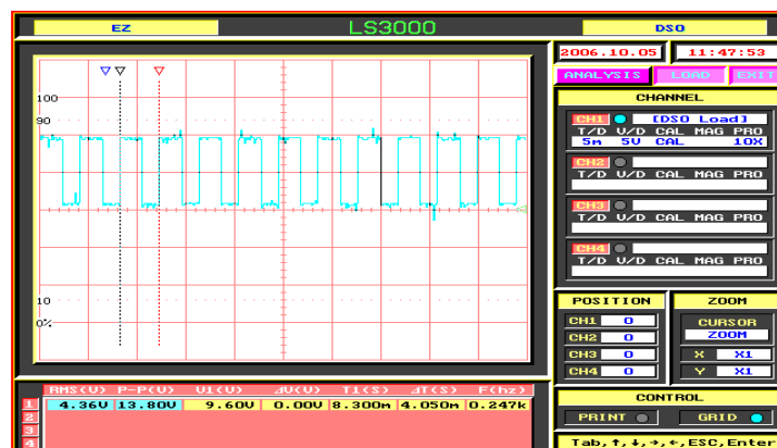
Gambar 11. Keluaran penguat penerima pada jarak 2 meter
